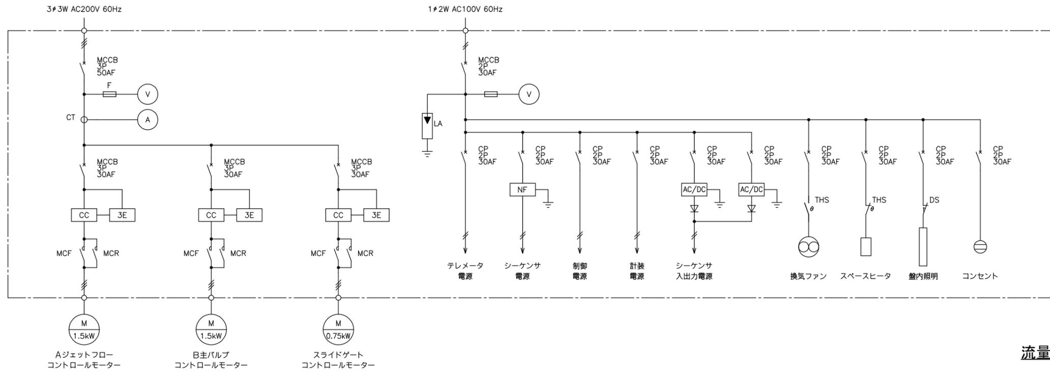
流量調節制御盤外形図・単線結線図
